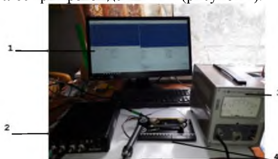
Рисунок 1 — Электроизмерительный комплект оборудования для исследования влияния различных обработок на электросопротивление 1 — персональный ПК (интерфейс программы); 2 — цифровая USB приставка «Вектор-L»; 3 — милливольтметр ВЗ-48А; 4 — измерительная ячейка
