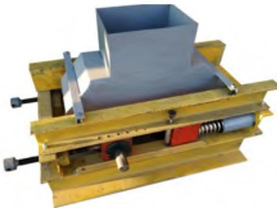
Рисунок 2 — Вибровалковый измельчитель-активатор
