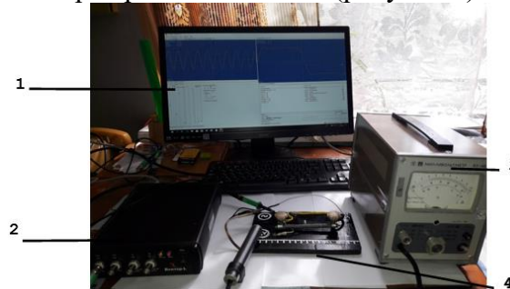
Рисунок 1 — Электроизмерительный комплект оборудования для исследования влияния различных обработок на электросопротивление
