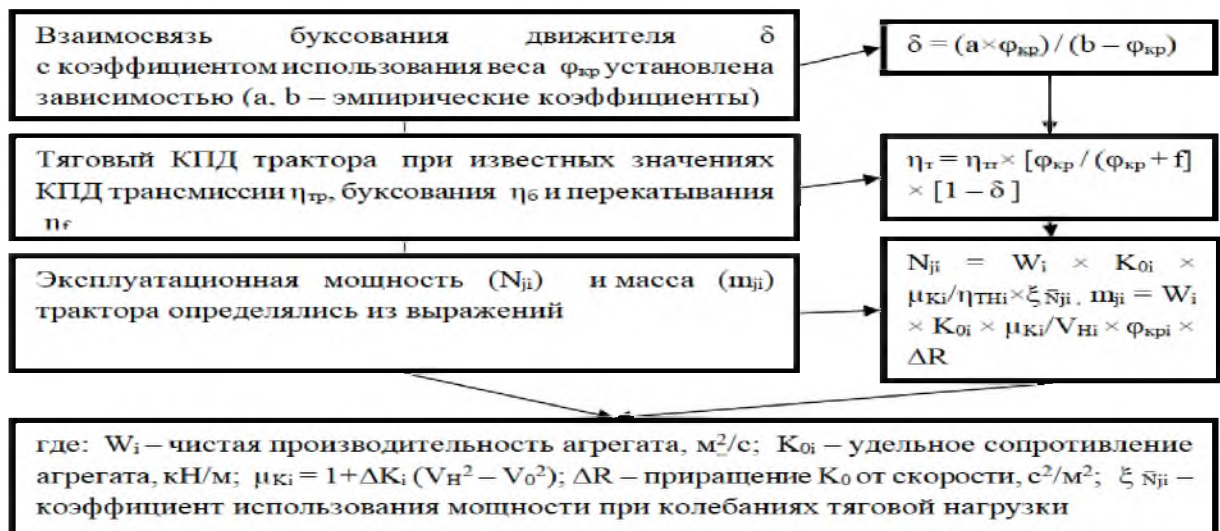
Рисунок 3 – Расчет и моделирование параметров гусеничного трактора (классический, ТГО)
