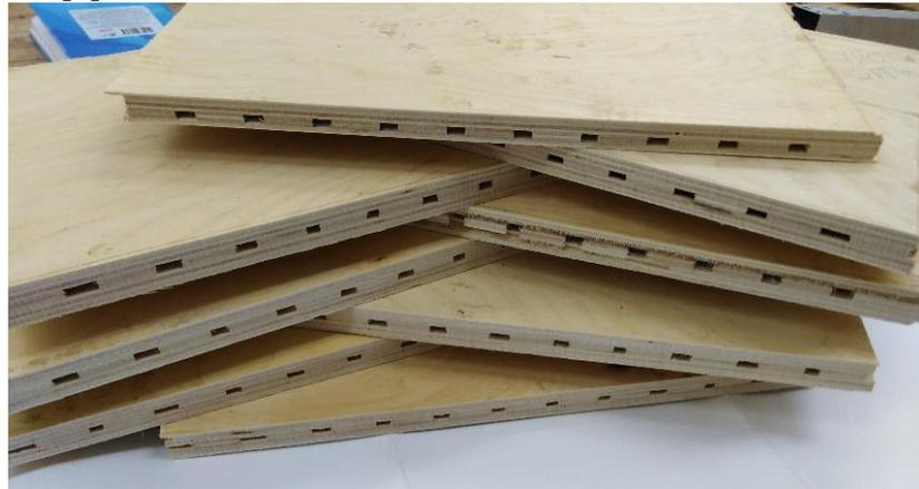
Рис.1. Опытные образцы фанерной панели
