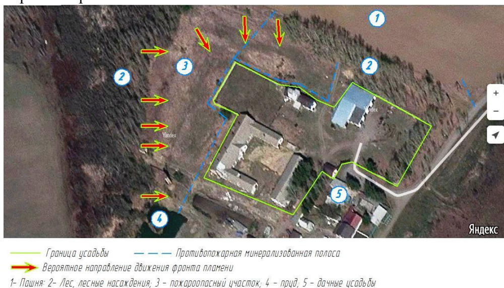
Рисунок 2 – Расположение противопожарных полос для защиты усадьбы
