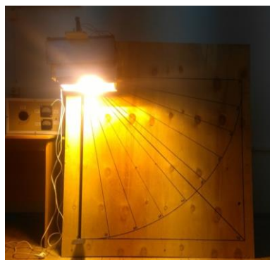
Рисунок 5 – Расположение облучателя ЖСП 37-400-001 с лампой ДНаТ-400 в продольном положении относительно измерительного фотометра.
