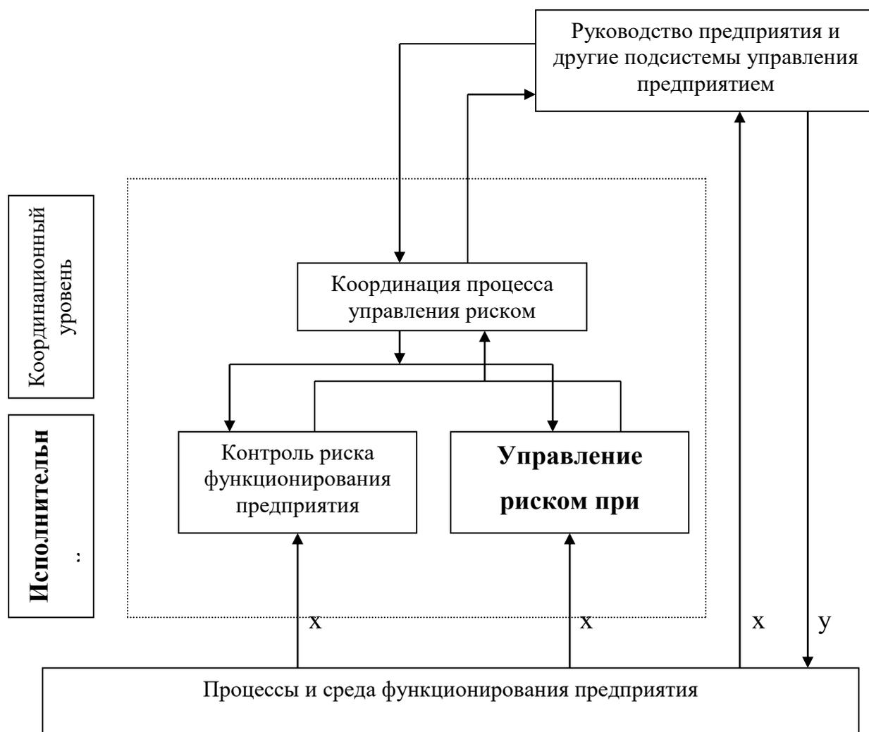
Функциональная структура управления риском на предприятиях мясной промышленности ( $x$  – управляемые переменные,  $y$  – управляющие воздействия)
