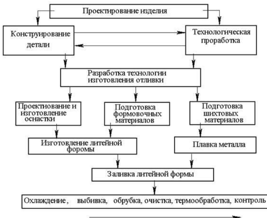
Рисунок 5 – Схема получения отливки
