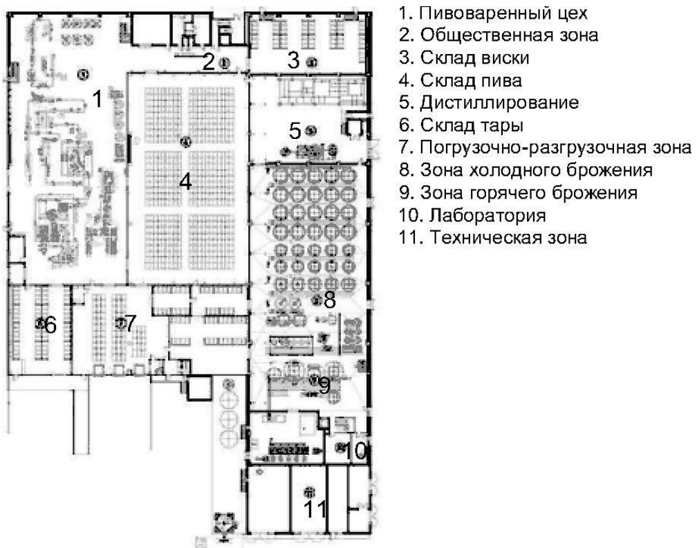
Рисунок 7 - План первого этажа фабрики в Тараре, Франция, с экспликацией помещений
